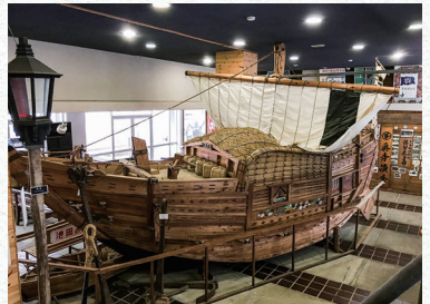
船模型 500石積弁財船の3分の1サイズの模型。材料は実物と同様にスギ、ヒノキ、ケヤキ等が使用されている。設計製作は酒井久蔵。
