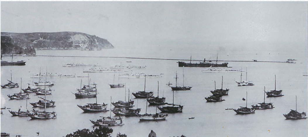
小樽港。明治36（1903）年。帆柱が1本の弁財型和船と、帆柱が2本の和洋折衷型帆船（合いの子船）、沖合には商船が見える。中央は明治政府がイギリス海軍から購入し、のちに日露戦争に出撃した駆逐艦。様々な船種が混在していることが、北前船寄港地としての小樽の特徴。
