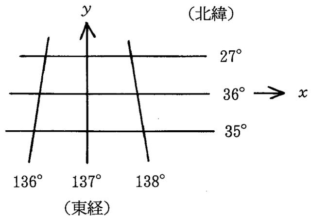
北緯  $\beta^\circ$  東経  $\alpha^\circ$  の点の、平面座標 (X, Y) を、
